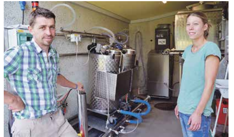
Evelyne und Hansruedi Peter zeigen die Pasteurieranlage auf ihrem Hof. Die frische Milch kommt in den grossen Tanks (Mitte) in den Automaten.
